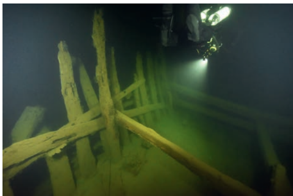
Figur 10. Bilden visar skeppet från insidan av styrbords-sidan. Här ser man bland annat de förstärkande intimren. Även de dubbla balkarna som förstärker stormasten syns. Foto: Jim Hansson, SMTM.
