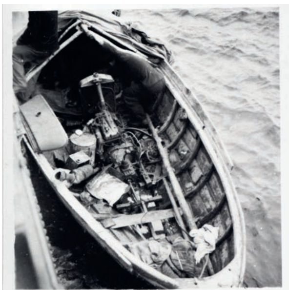
Figur 3. På ett ramverk av vidjor har en presenning spänts upp som skydd över båtens öppna förskepp. En motor från en A-ford modell 1931 (alternativt den sovjetiska licensbyggda kopian GAZ-A som tillverkades mellan 1932–1936 i bland annat Riga) har tillsammans med växellåda, instrumentering, torped med bensintank, kylare och ram installerats i flyktbåten. När båten undsattes hade den drivit redlös under ett dygn och ett barn ombord hade avlidit. Foto: David Holmert. Ur Bengt-Göran Holmerts personarkiv, Landsarkivet i Visby.
