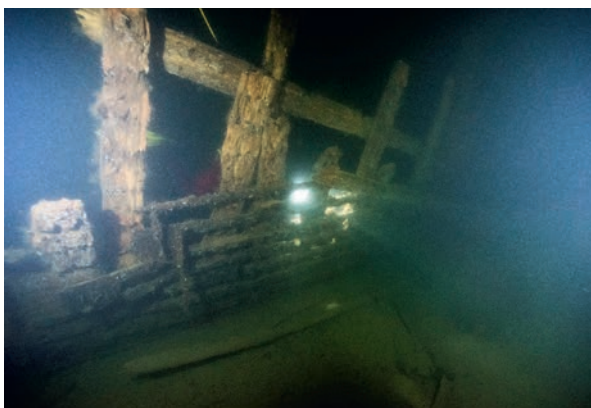
Figur 5. Bordläggningen på vraket är väldigt eroderad. Det är nitraderna som är bevarade. Skrovet i sig är väldigt "skrovhelt" för att vara klinkbyggt; sådana skrov faller vanligen snabbt isär. Foto: Jim Hansson, SMTM.
